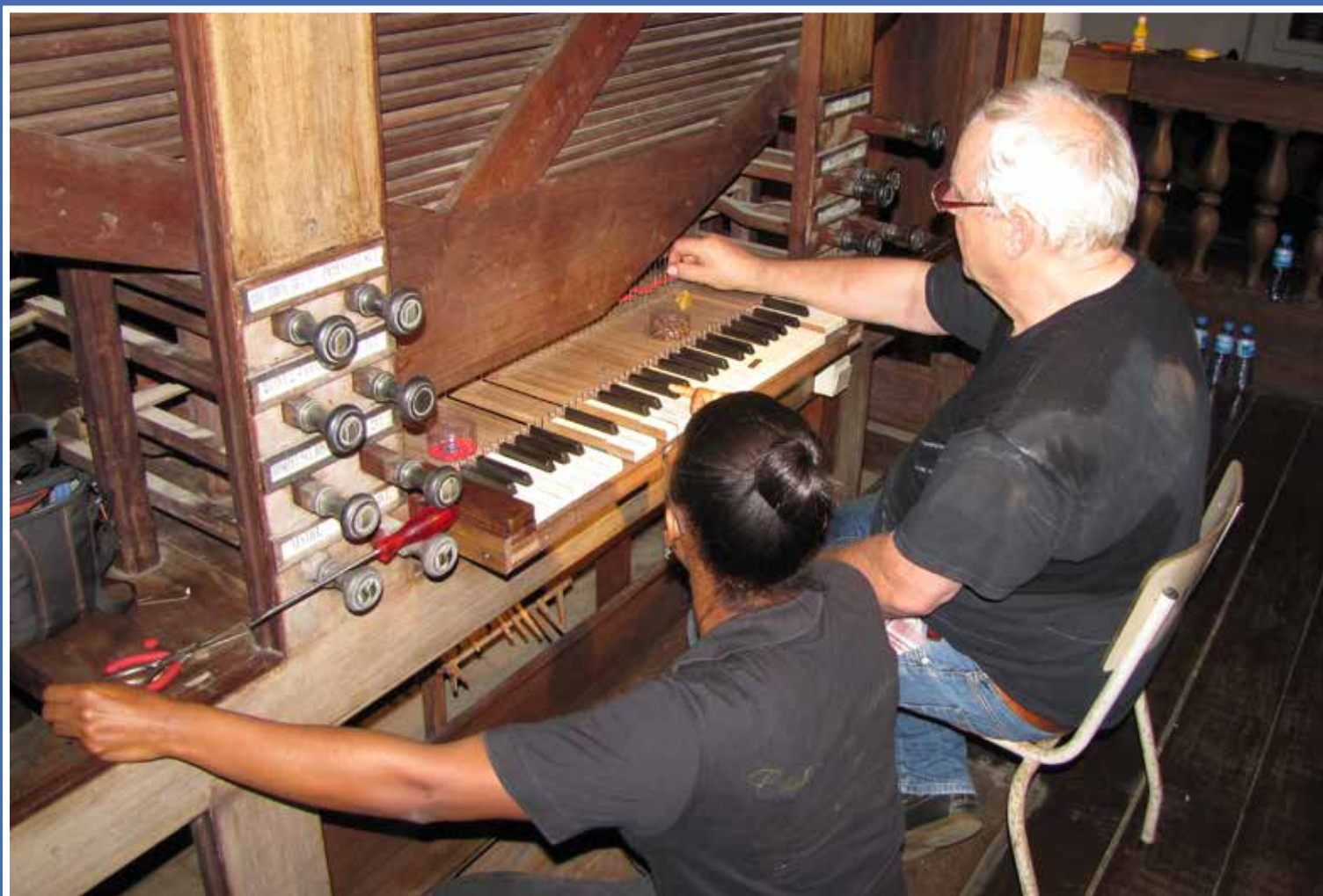
ORGELMAKER PETER VAN RUMPT INSTRUEERT DE SURINAAMSE RESTAURATOR, ANASTATIA VAN OMMEREN, BIJ HET AFREGELLEN VAN HET KLAVIER VAN HET BÄTZ-ORGEL IN DE LUTHERSE KERK TE PARAMARIBO.
