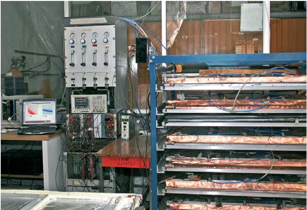
7. EQUIPO EXPERIMENTAL para la detección de muones. A la derecha, el conjunto de las seis cámaras multilámbricas con los dos centelladores. Abajo a la izquierda, la electrónica necesaria para
